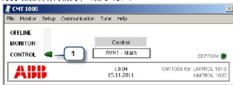
图 6-13 在可选项软件使能之前必须使 CMT1000 在控制访问模式下
